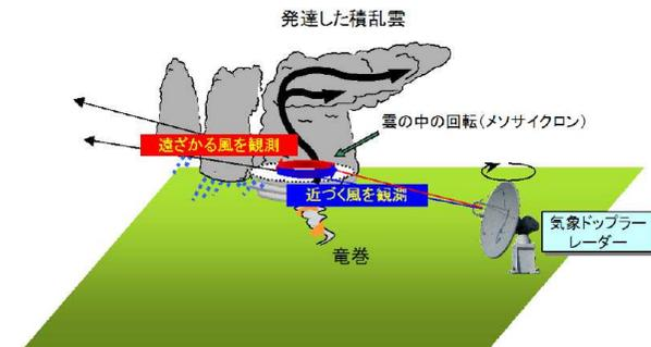
竜巻発生確度ナウキャストにおける気象ドップラーレーダーを用いた観測※1
