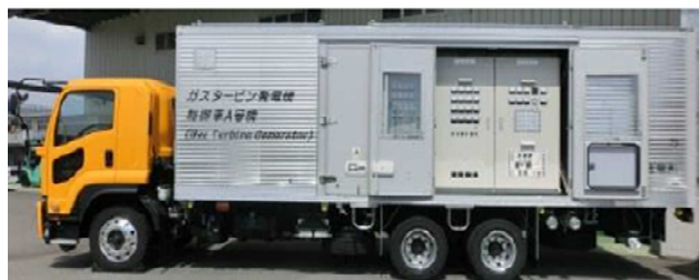
ガスタービン発電機
