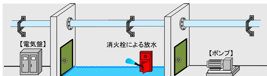
図3 消火水の放水による溢水(イメージ)
