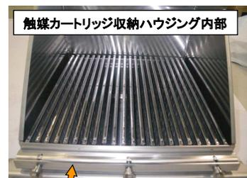
22枚の触媒カートリッジが収納されている
