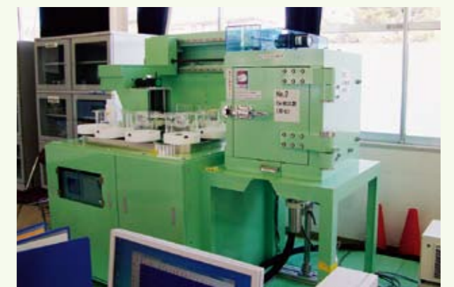
新たに設置したゲルマニウム半導体検出器(旧消防学校内)
