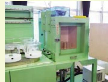
処理を済ませた試料は、ゲルマニウム半導体検出器などを用いて、放射性物質の種類と量を測定・解析します。測定器は外部の放射線の影響を受けにくい構造になっています。
