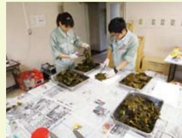
正確に測定するために、採取した試料から余計なものを取り除いたり必要な部分を取り出したりして測定するための試料とし、その量を測っておきます。
