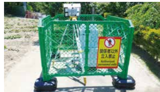
震災直後より代替で設置した可搬型モニタリングポスト
