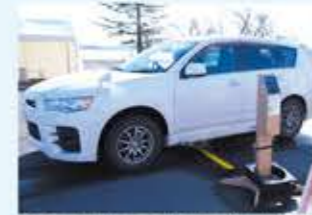
①ゲート型モニタによる汚染検査(南郷体育館)
