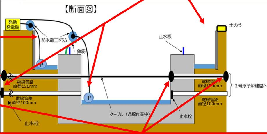
② ケーブル敷設作業が完了するまでの期間、ケーブル電路の貫通部に雨水の流入を軽減するためのシール処置を行う。
