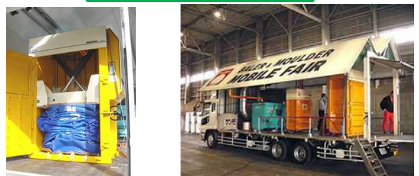
4袋分の圧縮物を1袋 の大型土のうに封入 し、バンドで結束
