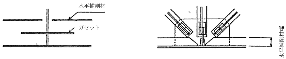
図4-52 水平剛材と横構部材との取り合い
