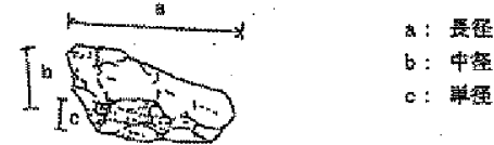
図1-5-1 礫の計測方法
