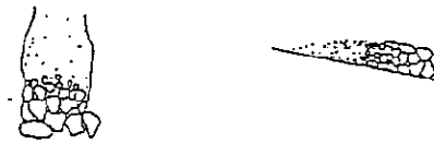
図 1-5-5 土石流による堆積状況
