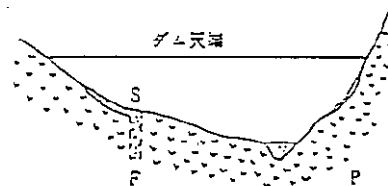
図 3-2-5 断層型 (洪積礫層を切る若い断層) P 変朽安山岩 F 断層破碎帯 S 湧泉
