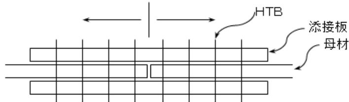
図2-1 ボルト締付け順序
