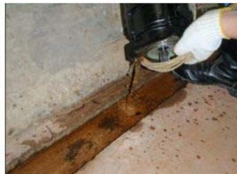
水没流量計内のモーター（乾燥後、再使用）
