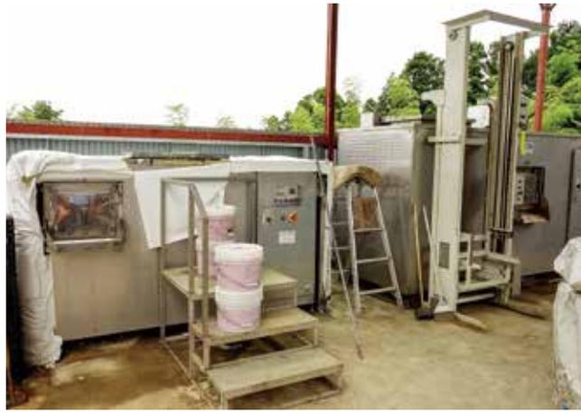
右／手前の小さい設備が牛タンの皮などの動物性の廃棄物、奥の一回り大きい設備が植物性の廃棄物の堆肥化に使用されている。
