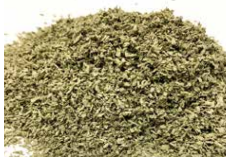
▲破碎した屑・端材等の再生材
