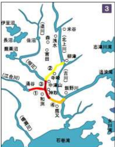
元和2年～元和8年(1616～1620) ①元和2年(1616)江合川と迫川を合流(短台地峡の開削) ■ ②元和3年～6年(1617～1620)柳津～猪岡短台開削麻崎村小麻に閉切堤防を築く ■ ③神取山を迂回する河道の掘削(人工狭窄部をつくる) ■ ④河道拡幅工事(元和7年～8年)(1621～1622) ■
