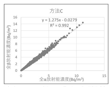
図 9 2021 年度の飯子浜局における方法 C により算出される全  $\alpha$  放射能濃度と全  $\beta$  放射能濃度の相関
