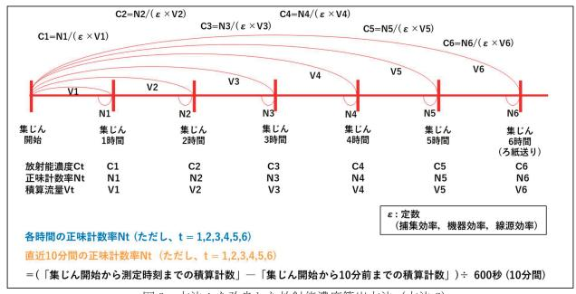
図3 方法 A を改良した放射能濃度算出方法(方法 C)
