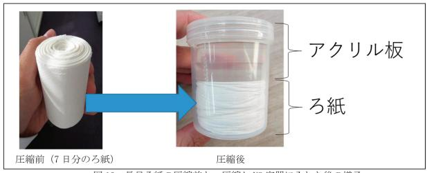
図 10 長尺ろ紙の圧縮前と、圧縮し U8 容器に入れた後の様子
