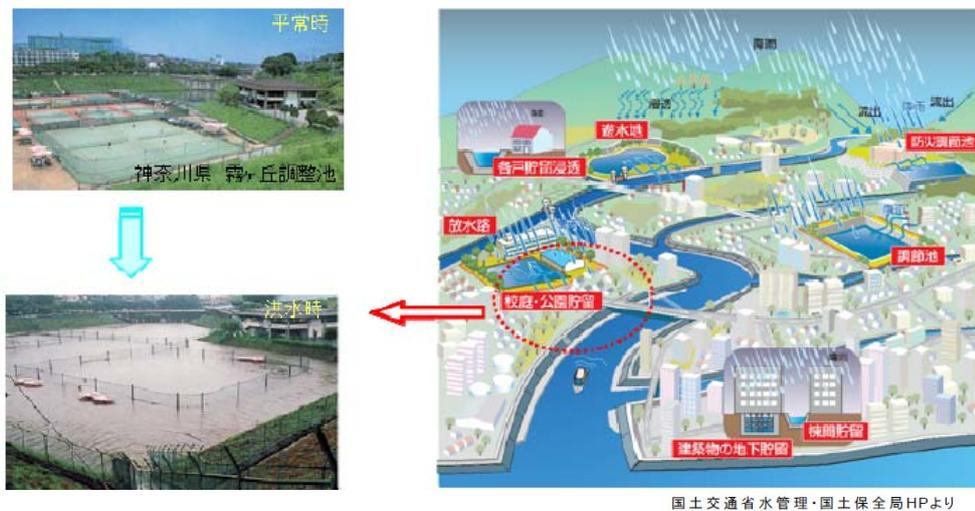
図 4-14 雨水貯留施設イメージ図
