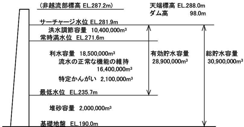
図 2-48 筒砂子ダム容量配分図
