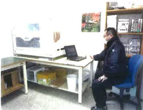
放射性物質測定機器(土壌、生乳) テクノエックス FD-08Cs100 オートサンプラー式
