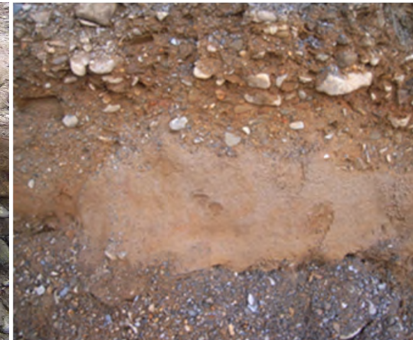
洪積砂利層に見られる互層構造(洗掘のされ方が一様でない)
