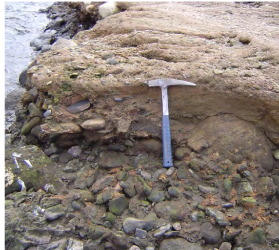
洪積砂利層に見られる互層構造(洗掘のされ方が一様でない)
