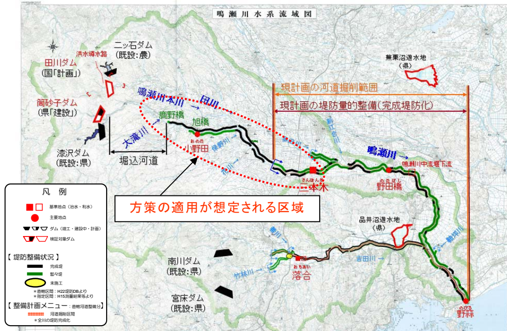
図 4-6 遊水地の設置が想定される区間
