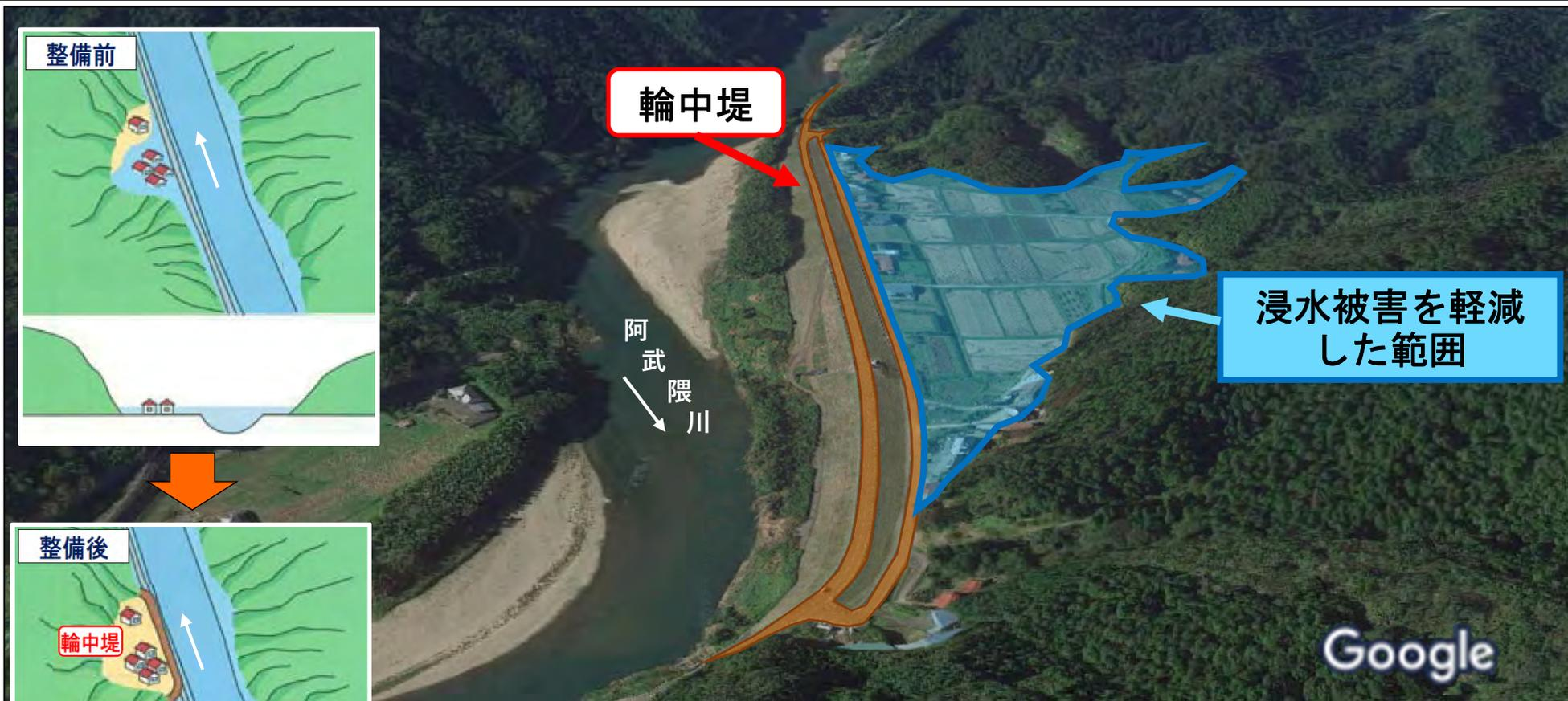
●部分的に輪中堤を整備することで、狭窄部沿川の家屋・農地浸水の被害軽減を図った。
