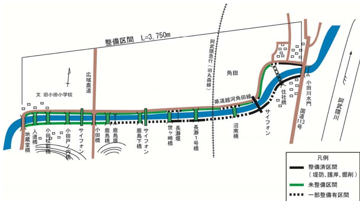
図 1-17 河川工事の進捗状況
