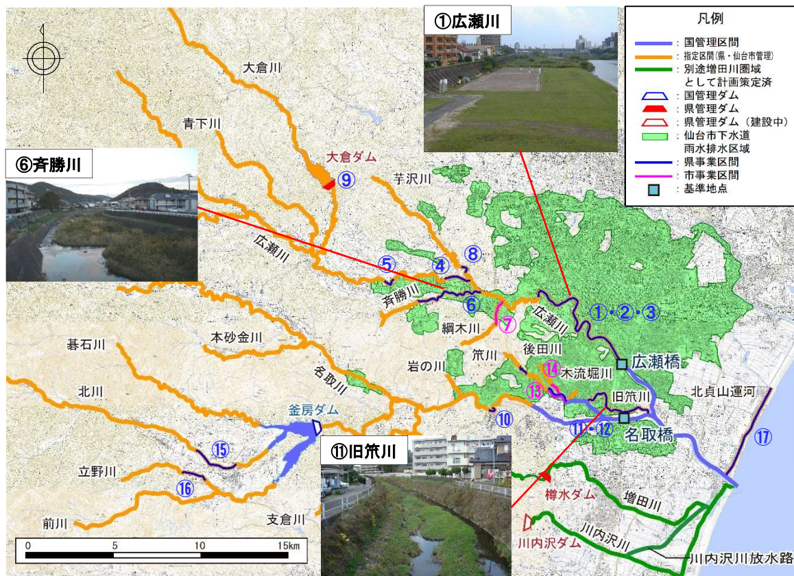
図 1-13 名取川水系県管理区間における主な改修事業区間
