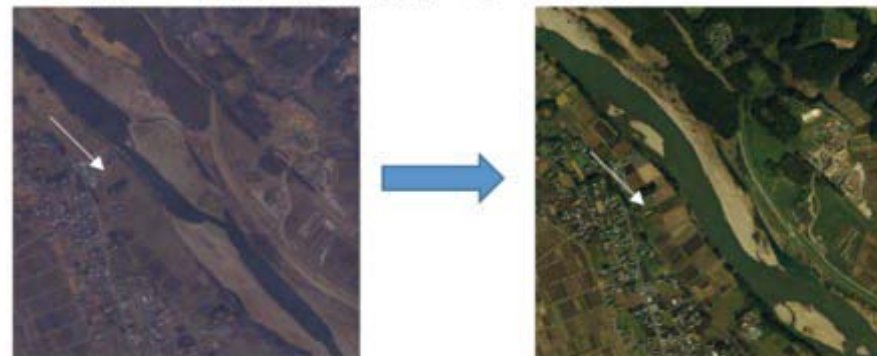
イメージ図：洪水前後の画像を用いた河道内土砂や植生の自動把握 例：那珂川の令和元年台風19号前後航空写真（国土地理院）
