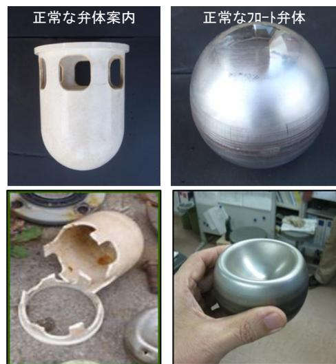
写真 1 弁体案内破損
