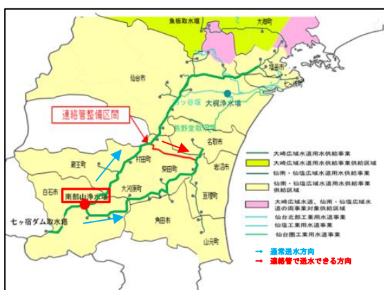
仙南・仙塩広域水道 高区・低区連絡管
