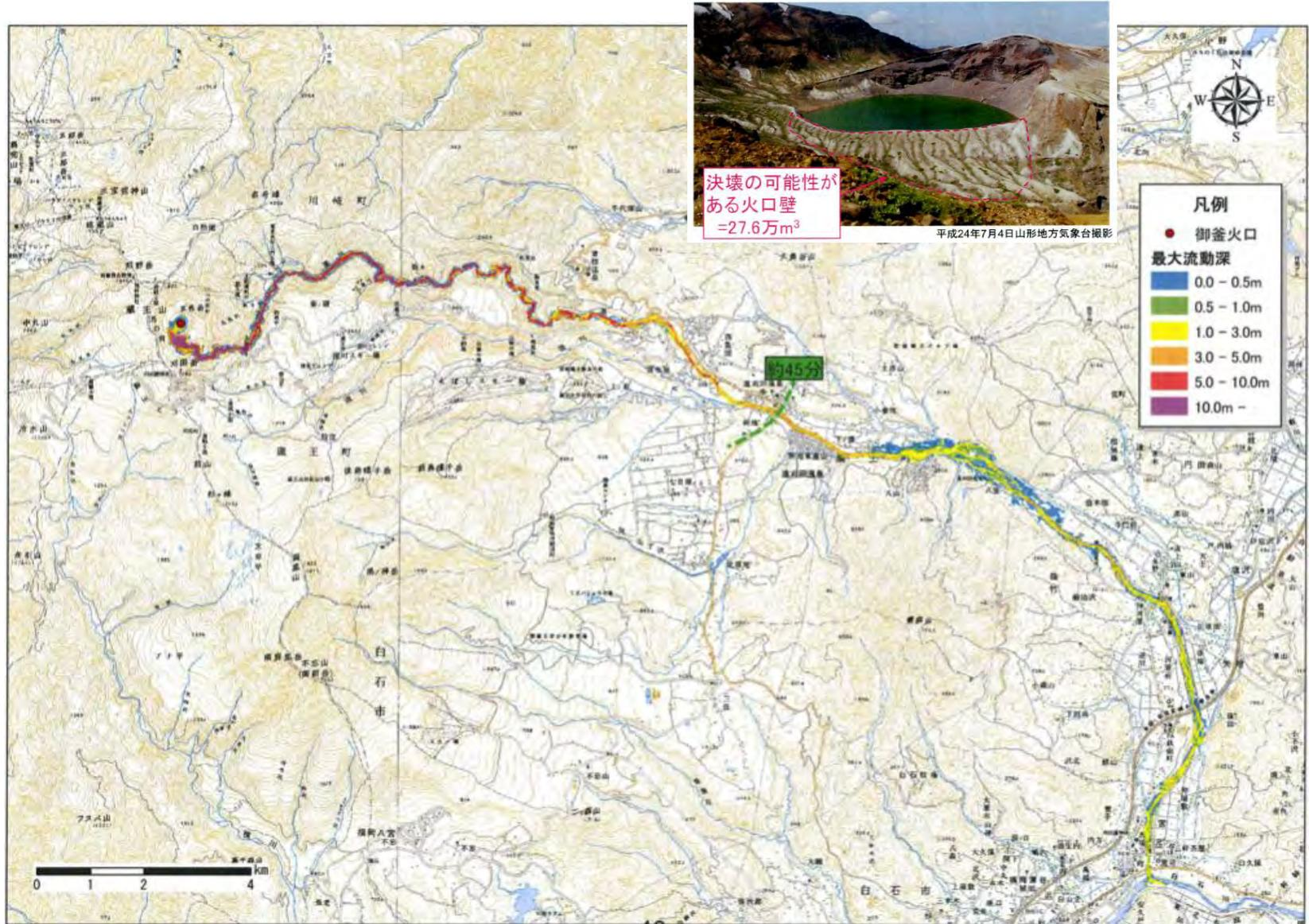
水蒸気噴火、マグマ噴火を問わず、御釜からの噴火により溢水または火口壁決壊による泥流が濁川を通り蔵王町の居住地域で氾濫するおそれがある。
