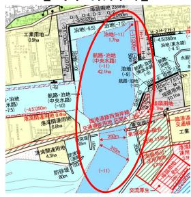
岸壁 水深11m×300m 岸壁 水深 9m×50m(物資補給岸壁) 中央水路 水深11m 釜航路 水深11m
