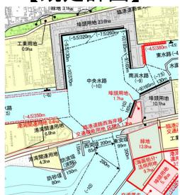
岸壁 水深10m×185m 岸壁 水深 9m×165m 中央水路 水深10m 釜航路 水深10m
