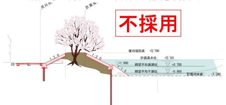
新たに盛土をすると、根腐れを起こして枯れてしまう 天端被覆ができないため、出水時に堤体が洗掘を受ける
