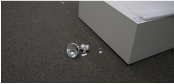
写真6 落下して破損、飛散したスポットライト(観覧者には当たらなかった。不幸中の幸いか。)
