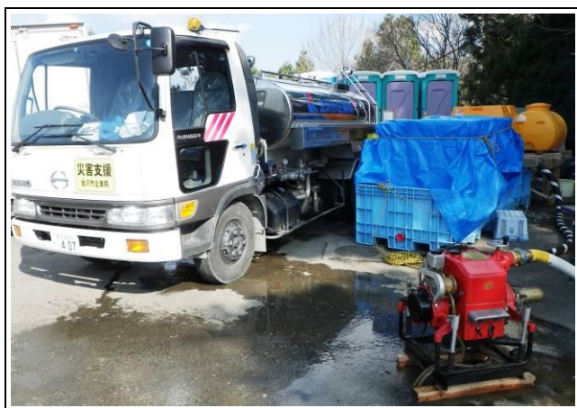
(給水車とくみ上げ用のポンプ)
