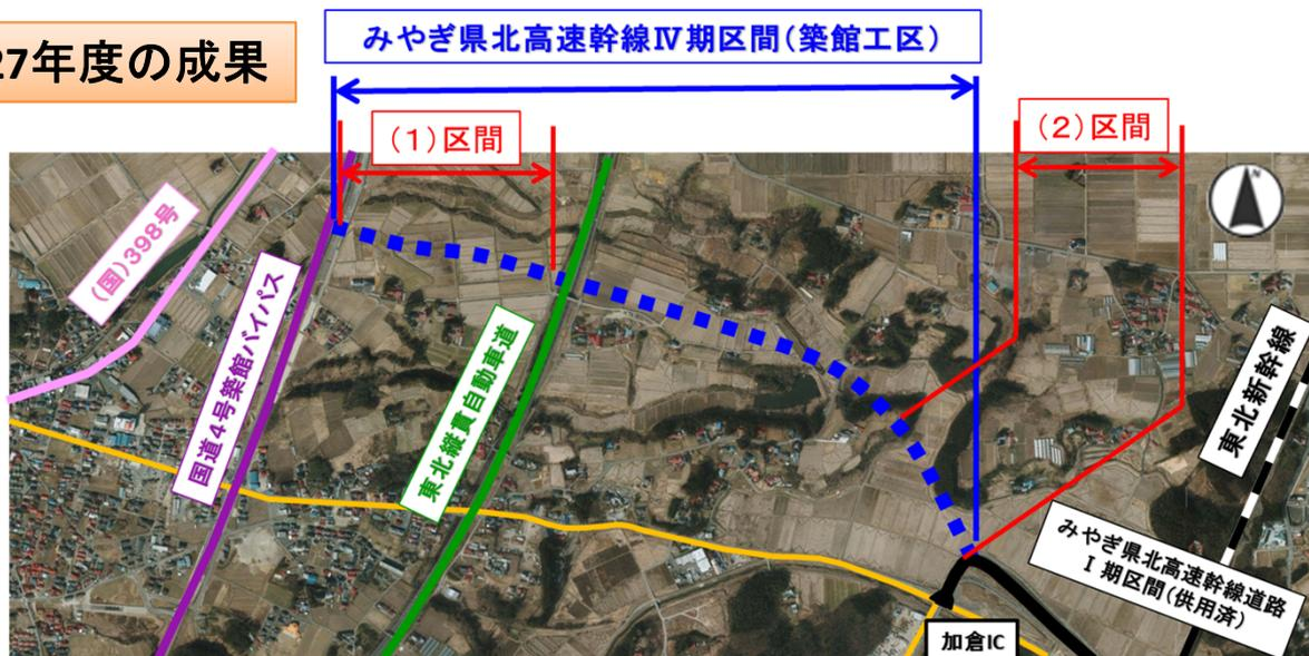
本工区については、(1)区間及び(2)区間で、昨年度末までに道路改良工事が3件完成し、合わせて約66,000㎡の盛土及び5基の函渠工などの工事が完成しました。
