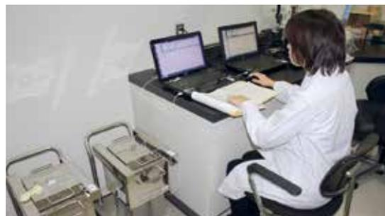
写真 NaIシンチレーションスペクトロメータによる簡易検査
