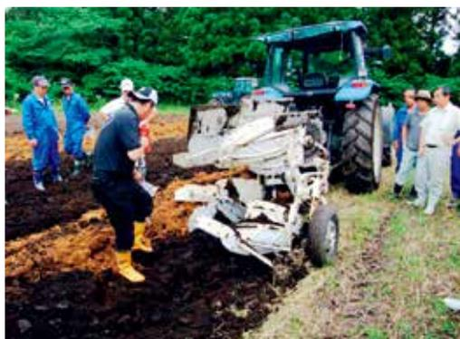
写真 反転耕による除染作業
