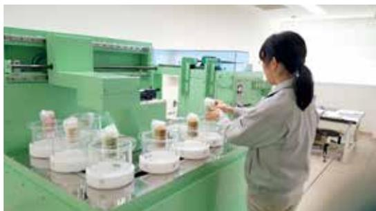
写真 ゲルマニウム半導体検出器による精密検査
