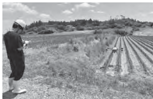
ドローンによるねぎの防除省力化試験
