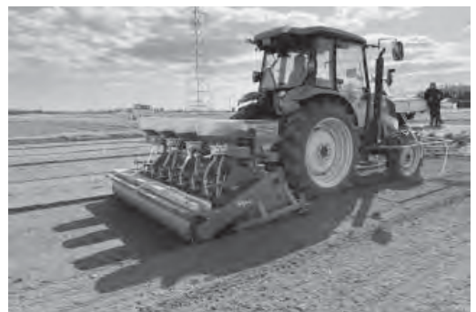
スリップローラーシーダーでの播種作業
