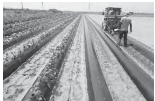
自動操舵システムによるうね立て
