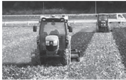
ロボットトラクタ協調耕起（東松島市） 注)手前:無人ロボットトラクタ,奥:有人トラクタ
