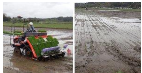
図3 アシスト田植機(左)による田植え状況(右) ※非熟練者でもベテラン並みの田植え精度
