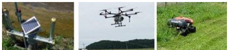
図7 右から遠隔水管理制御装置、農薬散布用ドローン、ラジコン草刈機
