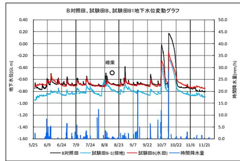
図4 試験田B地下水水位変動
