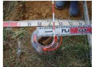
測定方法は、現場でスケールによる測定の外、右写真のような容器(開口部  $\phi 100 mm$ )を利用し、 $100 mm$  以上かどうかを判断する方法も考えられる。
