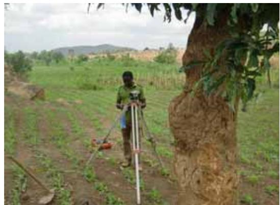
写真 27 , 28 : 事務所による水路勾配確認のための測量
