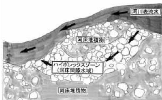
図1 湧水の発生機構模式図
