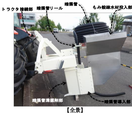
図5 浅層暗渠施工器 概要
