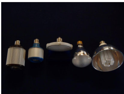
図1 各種光源の形状(左からLEDランプ1, LEDランプ2, LEDランプ3, 白熱電球, 電球形蛍光ランプ)
