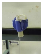
②給水タンクのコックを最初毎分300ml滴下するように調整する。
