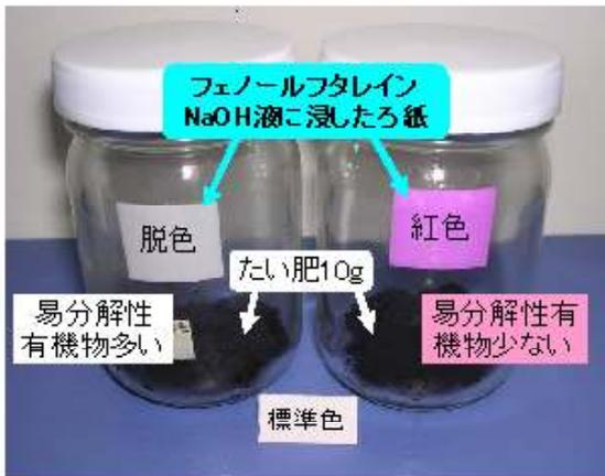
図3 フェノールフタレインの色変化を利用したCO<sub>2</sub>放出速度簡易測定
