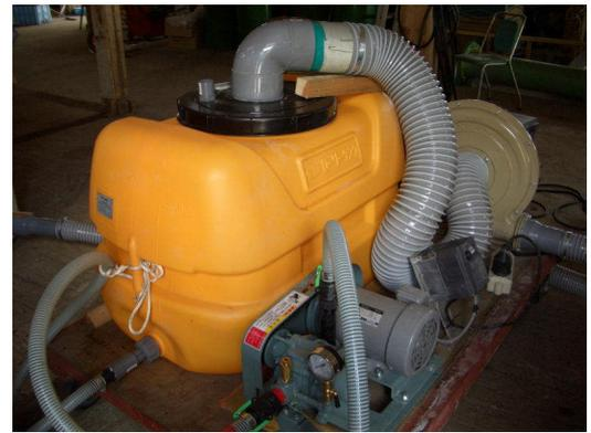
図2 散気管方式の脱臭装置
