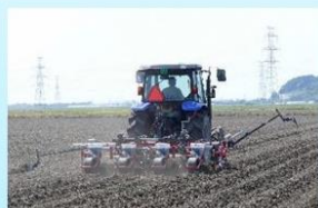
大豆用高速畝立て播種機による播種作業
