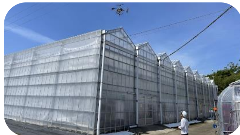
ドローンでの遮熱剤塗布によるハウスの温度昇温抑制効果の検証
