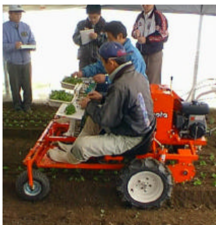
図4 直挿し作業機による作業状況
