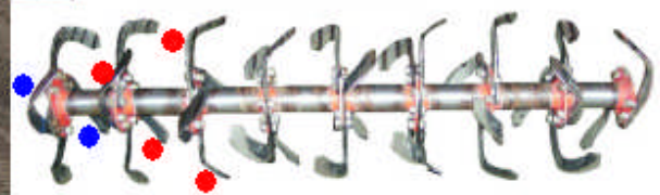
(耕耘爪の配列変更図はフランジタイプ)
