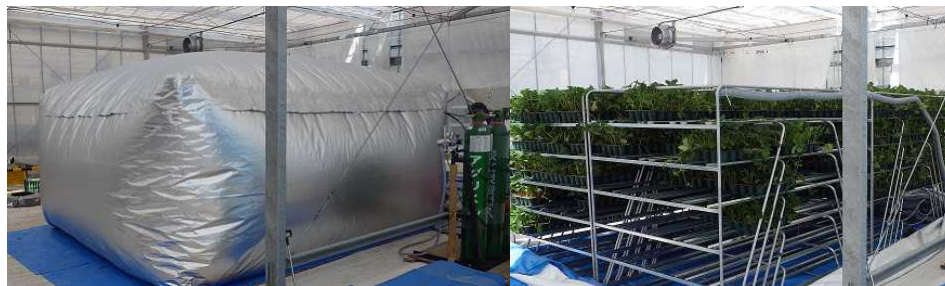
図1 二酸化炭素くん蒸装置と内部の状況 (TYPE10000 平成24年撮影)
